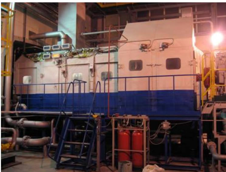
Рис. Газотурбинная приводная установка НК-16-СТД в защитном укрытии
