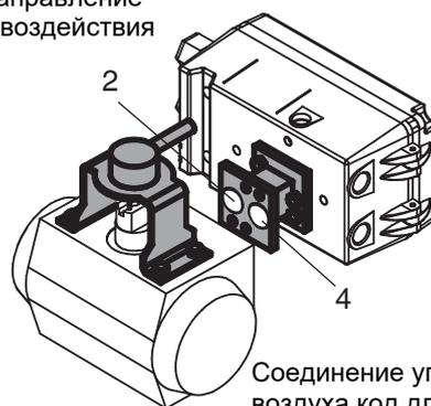
Соединение управляющего воздуха код для заказа ...HR
