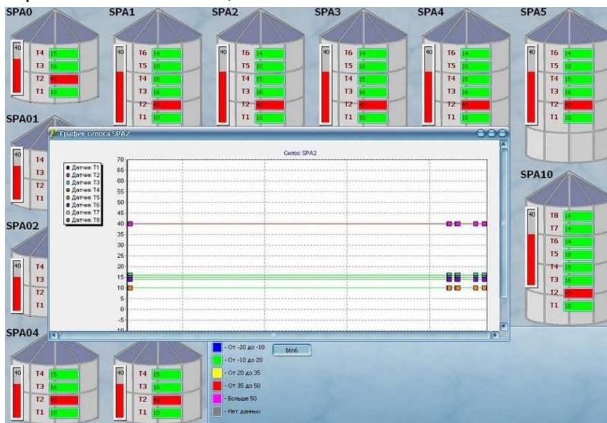
Рис.1. Пример рабочего окна клиентской части программы (вариант для металлических силосов).
